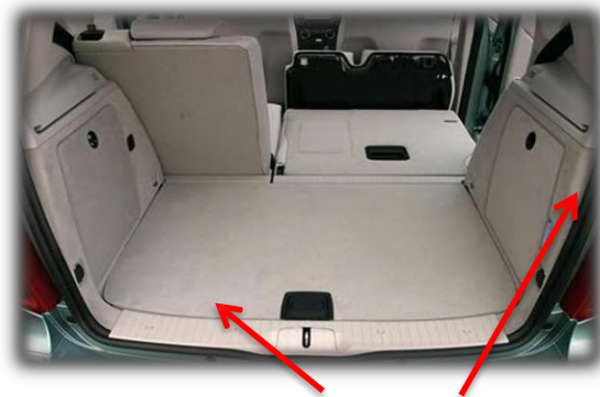
Doppelboden /erhöhter - Abnehmbaren Laderaumboden – bündig mit der Kunststoff-Heckklappe-Platte
