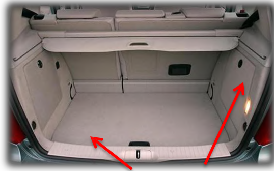
Doppelboden /niedriger oder Standard Boden. Laderaumboden sitzt niedriger als die Heckklappe-Platte
